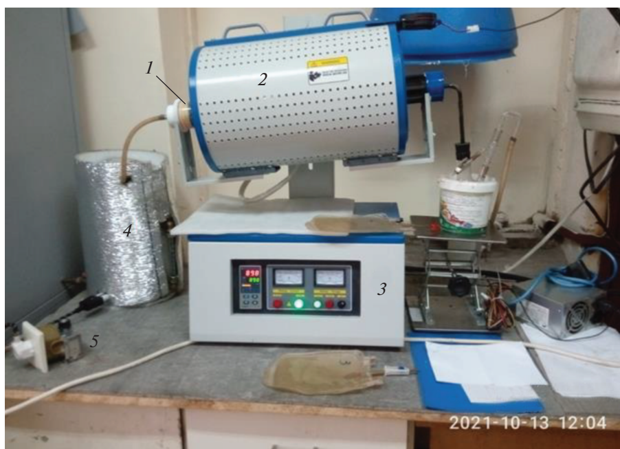
Рис. 1. Установка активации: 1 – реактор, 2 – трубчатая печь, 3 – блок управления, 4 – парогенератор, 5 – регулятор напряжения парогенератора.
