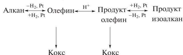
Схема 1. Процесс скелетной изомеризации.
