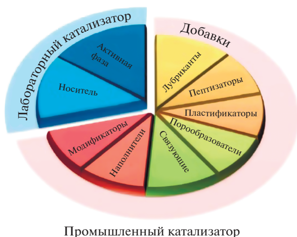
Рис. 2. Компоненты лабораторных и промышленных катализаторов [4].
