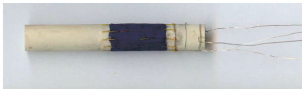
Рис. 1. Общий вид ячейки с неразделенными электродными пространствами (ТОТЭ с НЭП).
