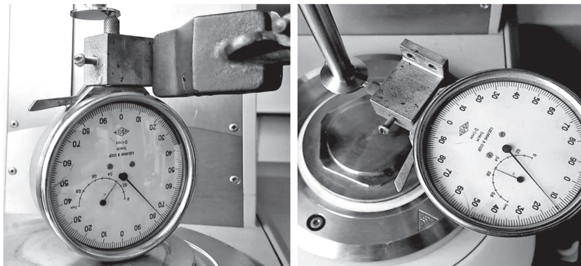
**Рис. 1.** Схема экспериментальной установки, демонстрирующая отсутствие пульсаций при вращении привода измерительного устройства.
