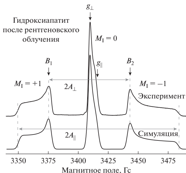
Рис. 4. Спектр ЭПР азотного радикала в матрице ГА, полученный с помощью детектирования интегральной интенсивности ЭСЭ, в зависимости от B_0 . Нижняя кривая – симуляция экспериментального спектра.
