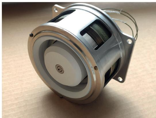
Рис. 5. Фотография экспериментального образца стационарного плазменного двигателя СПД-70.
