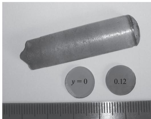
Рис. 1. Внешний вид кристалла  $Nd_{1-y}Eu_yF_{3-y}$  и изготовленных элементов для исследований.
