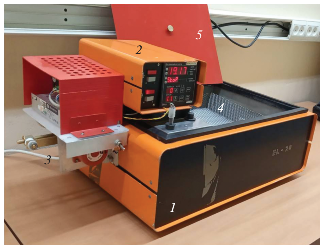
Рис. 1. Общий вид термостата-шейкера: 1 – корпус, 2 – блок управления температурой (ПИД-регулятор ТРМ151) и перемешиванием, 3 – привод подвижного лотка-держателя, 4 – лоток-держатель, 5 – крышка.
