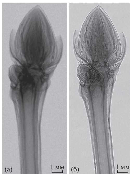
Рис. 4. Рентгеновские снимки почки кустарника, полученные в режиме: а – абсорбционного контраста ( R_1 = 1500 , R_2 = 0 мм), б – фазового контраста ( R_1 = 1500 , R_2 = 400 мм).
