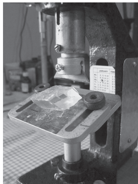
Рис. 2. Гильотина для раскалывания кристаллов.
