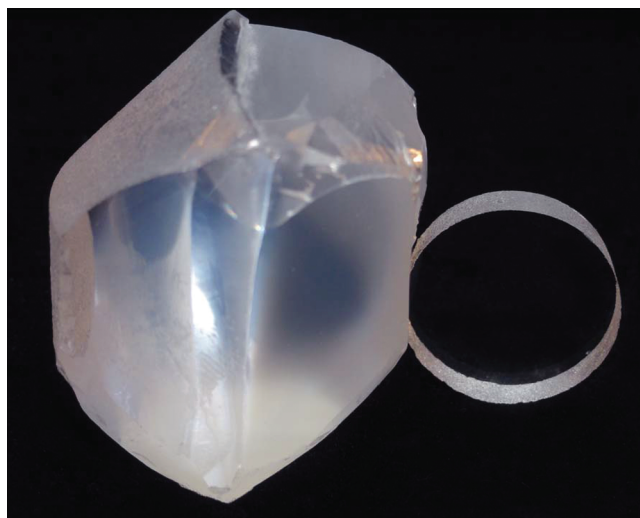
Рис. 2. Кристаллический блок \text{SrF}_2 из недофторированного сплава с выделениями частиц \text{SrO} (слева) и диск из того же дофторированного реактива (справа).
