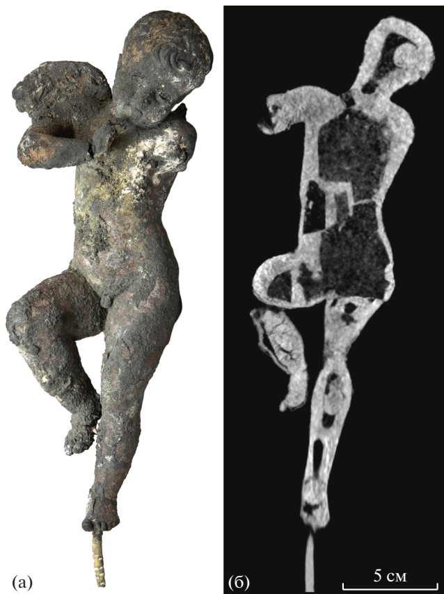
Рис. 15. Фотография статуэтки “Танцующий амур” (а) и ее продольное томографическое сечение (б), на котором видно повреждение правой голени [90].
