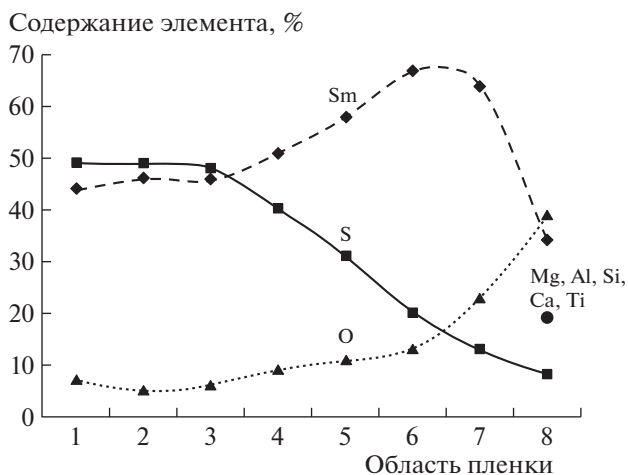
Рис. 3. Содержание элементов в исследуемой пленке SmS.
