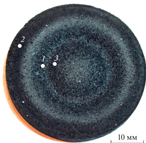
Рис. 1. Мишень 1.3Sm : 1S, используемая для магнетронного распыления.
