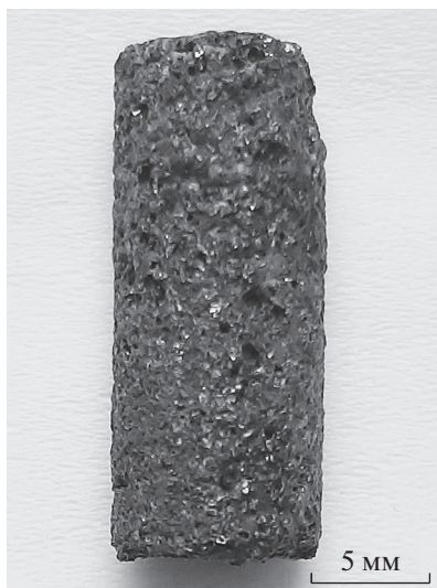
Рис. 1. Образец керамической мембраны на основе порошка SiC.
