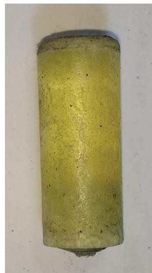
Рис. 2. Внешний вид булы (диаметр 12 мм), полученной направленной кристаллизацией расплава стехиометрического состава KDy<sub>3</sub>F<sub>10</sub> (25 мол. % KF по шихте).
