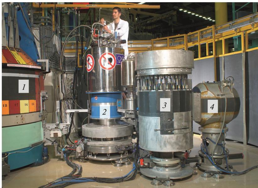
**Рис. 2.** Трехосный спектрометр IN14 в ИЛЛ (Гренобль, Франция) [5]: 1 – массивная защита монохроматора, 2 – стол образца со сверхпроводящим магнитом, 3 – анализатор, 4 – детектор, каждый в своей защите.
