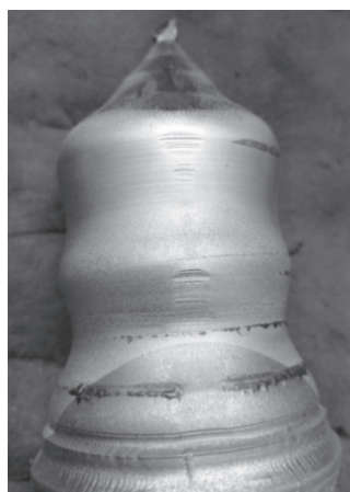
Рис. 6. Монокристалл GaAs диаметром 40 мм, легированный Те, с фасетками и двойником.
