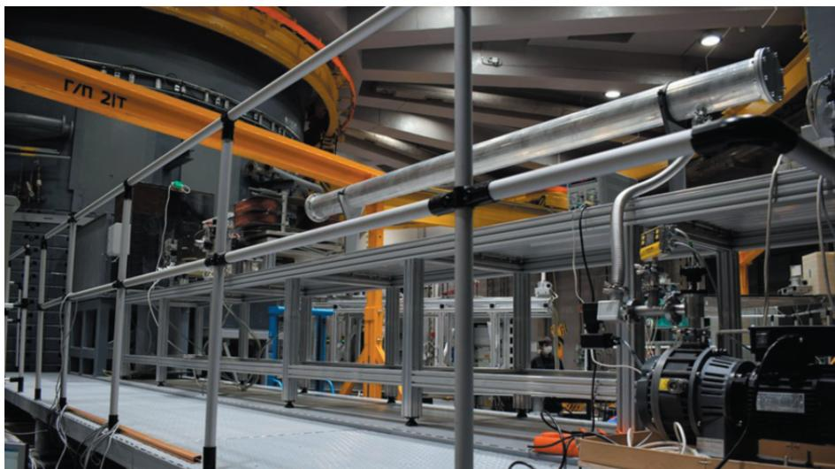
Рис. 11. Тестовый нейтронный рефлектометр.
