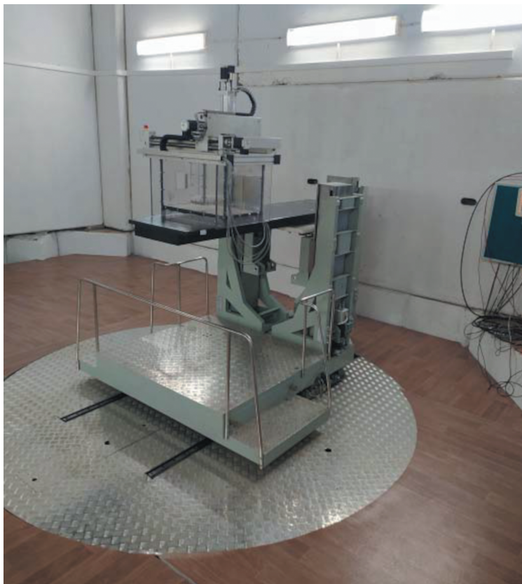
Рис. 7. Внешний вид прецизионного 6D-стола для облучения пациентов горизонтальным пучком.
