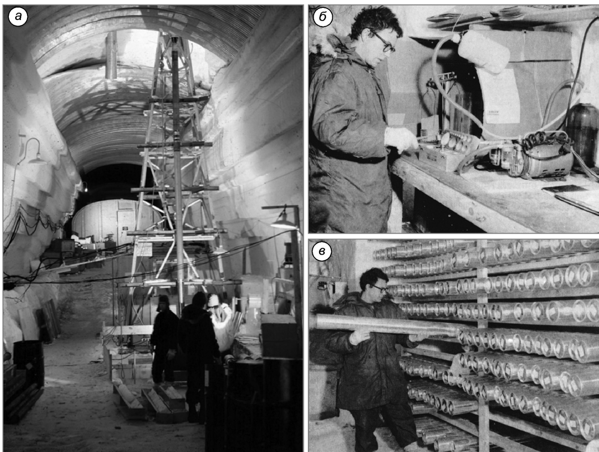
Рис. 6. Бурение глубокой скважины на Camp Century (а), фото Ч. Лэнгвея [3]; измерение плотности льда гидростатическим методом (б) и кернохранилище в подснежной траншее (в) [6].
