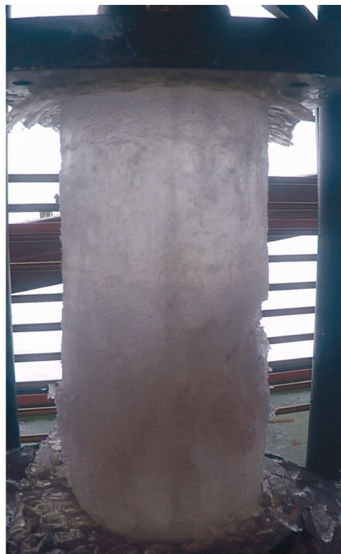
Рис. 2. Разрушение образца при испытании на одноосное сжатие в момент регистрации разрушающей (пиковой) нагрузки
