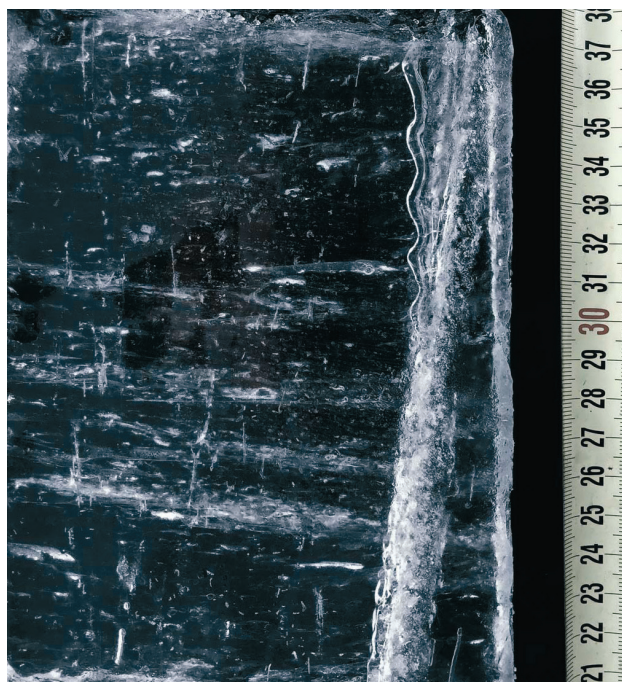
Рис. 5. Синусовидный канал на вертикальном срезе льда в отражённом свете, слой 2,62–2,82 м.
