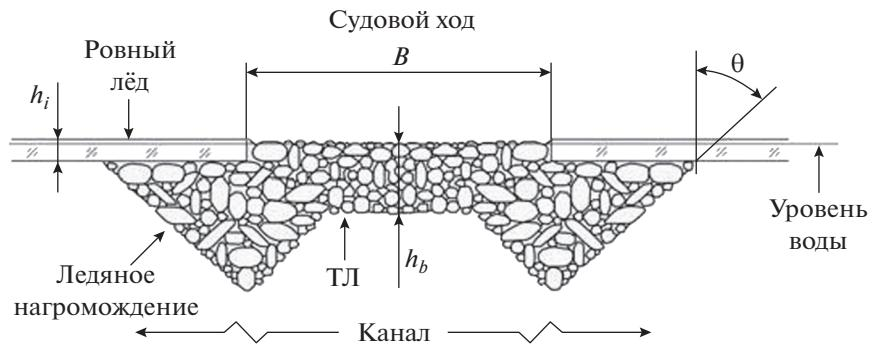
Рис. 1. Схема канала, заполненного тёртым льдом (Ettema, Huang, 1990).
