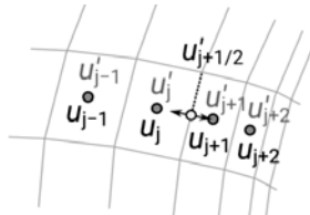
Рис.3. Аппроксимация производной на грани в нормальном направлении.
