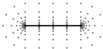
Рис.1. Расположение узловых точек для построения мелкой расчетной сетки около трещины ГРП. Узловые точки изображены серым цветом. Черной линией обозначена трещина ГРП.
