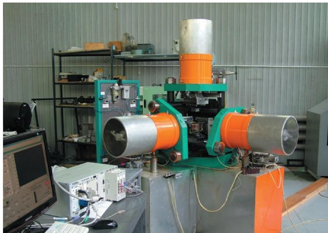
Рис. 2. Испытательная система трехосного независимого нагружения (ИСТНН)
