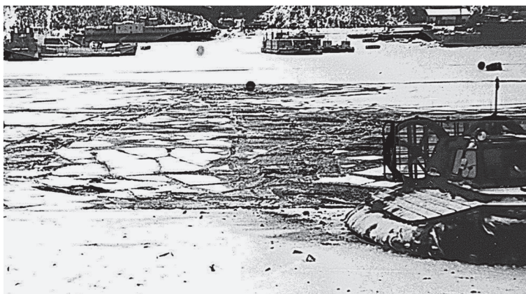
Рис. 5. Разрушение ледяного покрова СВП береговой охраны “Гепард”.
