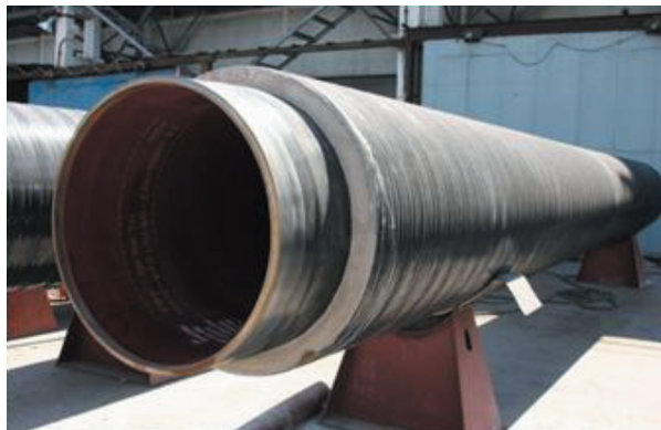
Рис. 1. Внешний вид обетонированной трубы.
