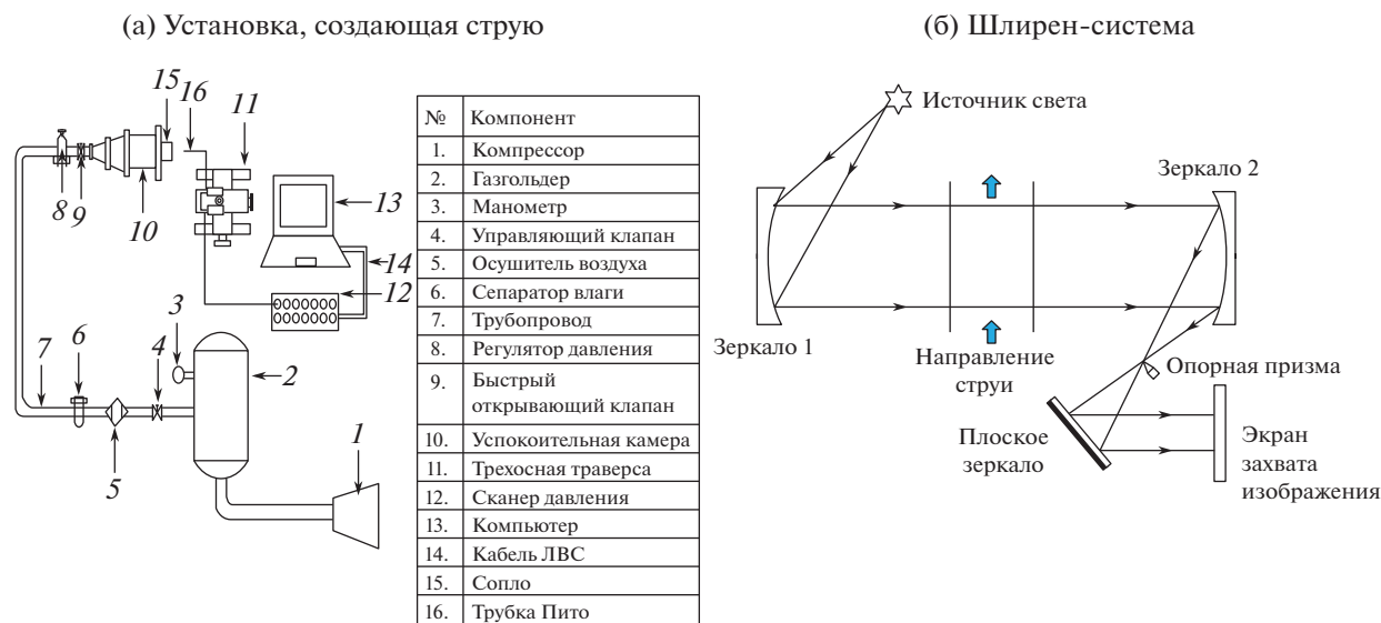
Рис. 1. Схема установки, создающей свободную струю (а) Установка, создающая струю; (б) Шлирен-система.
