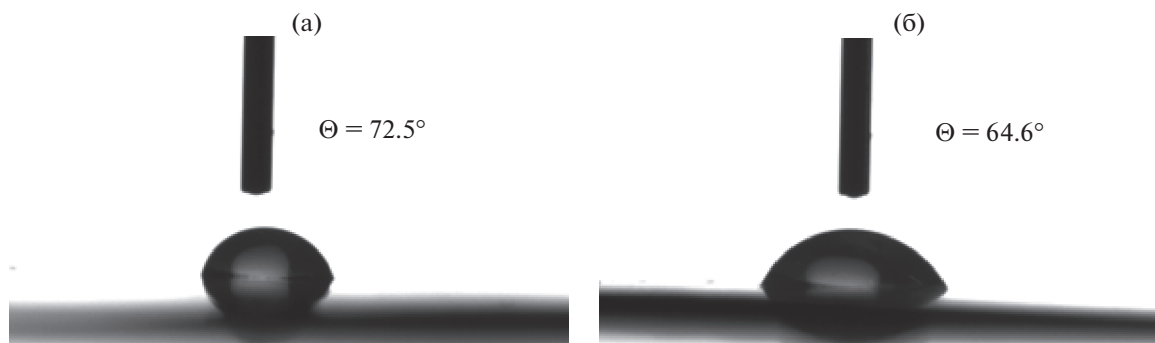
Рис. 3. Изображения капли дистиллированной воды с соответствующими значениями краевого угла смачивания АЦ мембраны: (а) исходной; (б) короннообработанной.
