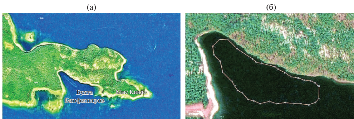
Рис. 1. Спутниковый снимок (отмечено место нахождения меромиктического желоба) (а) и батиметрический план с изобатой 8 м, полученный путем эхолотирования (б).
