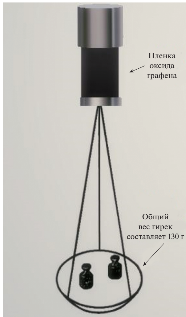
Рис. 2. Первичные испытания ПОГ на прочность. Кусочек ПОГ выдерживает нагрузку общей массой 130 г.
