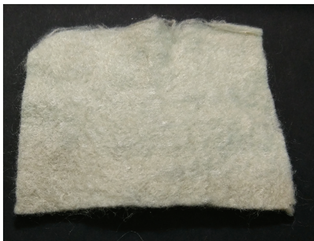
Рис. 4. Нетканый материал на основе композиционных нитей, содержащих 0.5% НФХ.
