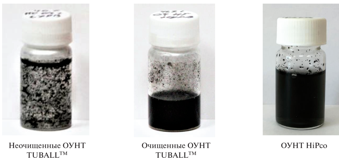
Рис. 2. Дисперсии ОУНТ в Survanta® 0.15 мг/мл в фосфатном буферном растворе (0.1 мг/мл).
