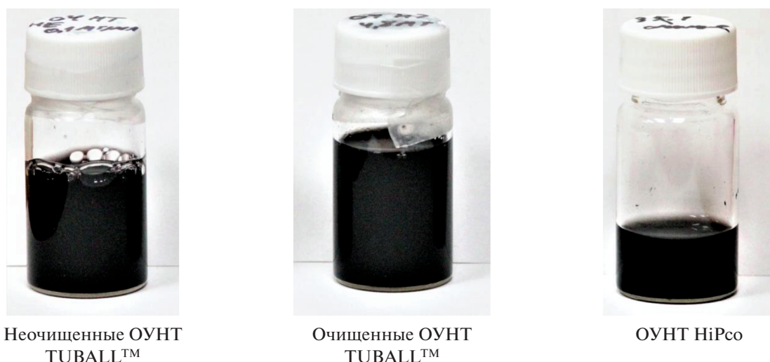
Рис. 4. Дисперсии ОУНТ в культуральной среде DMEM с добавлением 10%-ной бычьей сыворотки (0.1 мг/мл).
