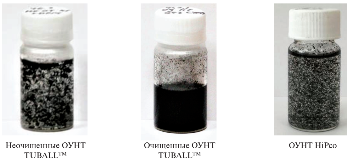
Рис. 1. Дисперсии ОУНТ в DPPC 0.01 мкг/мл в фосфатном буферном растворе (0.1 мг/мл).
