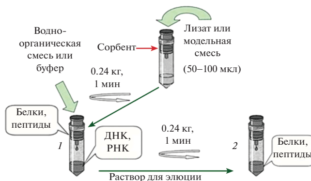
Рис. 5. Схема одностадийного выделения НК и последующего выделения белков (пептидов) с помощью разработанных сорбентов.
