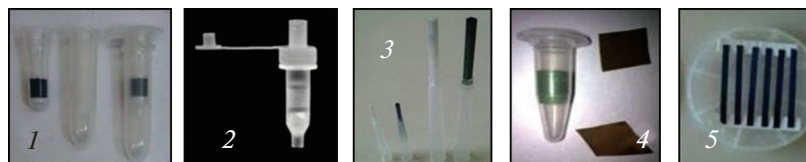
Рис. 4. Примеры БЭ: 1 – спин-картриджи с ПАНИ сорбентом, 2 – двухслойная концентрирующая спин-колонка (верхний очищающий слой – ФП-сорбент, нижний концентрирующий слой – гранулы сшитого полиакриламида), 3 – стеклянные мультикапилляры, покрытые нанослоем ПАНИ, впаянные в наконечник для механического дозатора, 4 – ПАНИ-модифицированная мембрана ММК-2, размещенная в картридже, 5 – кремниевые пластины с 3-АБК-ПАНИ-покрытием для масс-спектрометрии.
