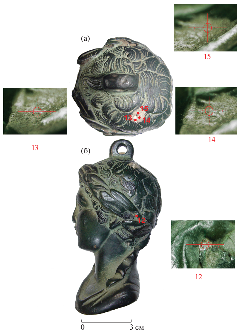
Рис. 2. Гири с Эклизи-Бурун: а – вид сверху, б – вид слева. Цифрами 12–15 на фигурной гире обозначены точки измерения состава сплава. Приведены микрофотографии исследованных областей. Диаметр исследованного пятна 0.6 мм.
