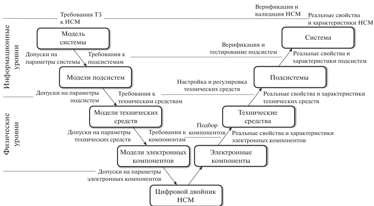
Рис. 1. V-диаграмма процесса разработки НСМ.
