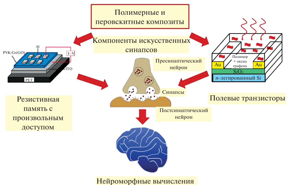
Рис. 1. Схема построения запоминающих устройств из полимерных и перовскитных композитных материалов, служащих базовой единицей для моделирования искусственных синапсов.
