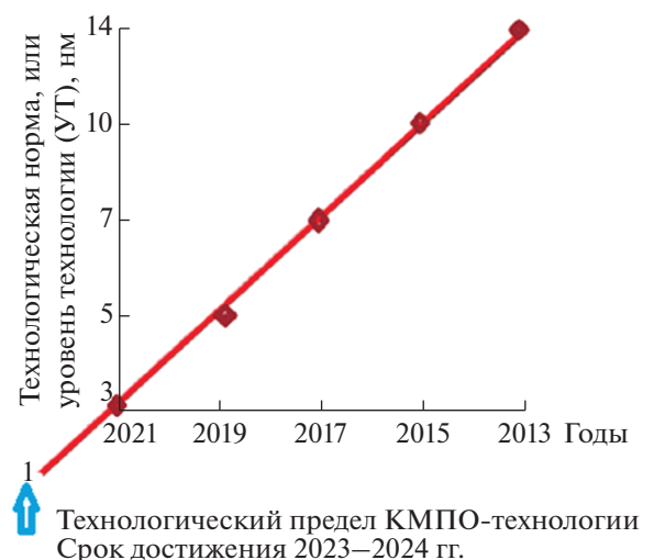
Рис. 3. Достижения планарной КМОП-технологии за 2013–2021 гг. (точки) и прогноз (линия) масштабирования на 2022–2023 гг., полученные по набором данных Института электротехники и электроники [2], Международной ассоциации производителей полупроводниковых приборов [3] и работы [11]. Уровень технологии эквивалентен термину Technology Node или размеру технологической нормы.
