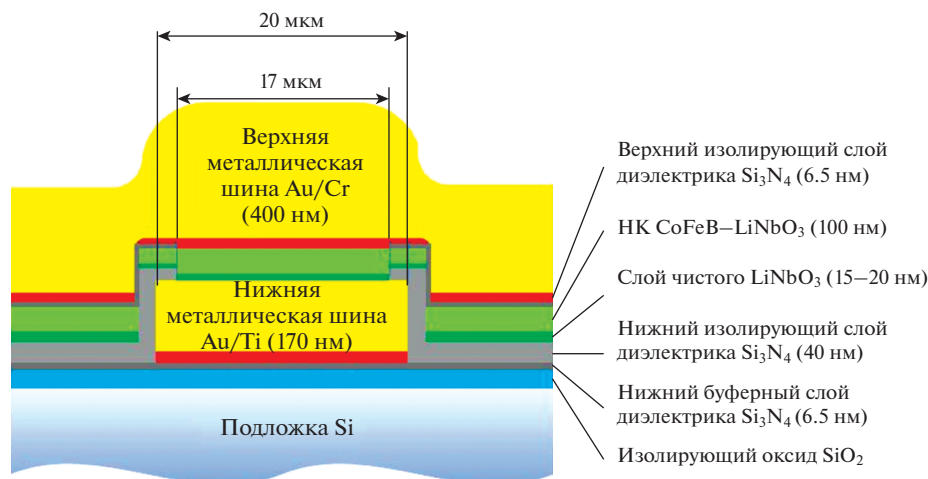
Рис. 1. Схематическое изображение сечения отдельного мемристового кроссбар-элемента на базе структур M/(\text{CoFeB})_x(\text{LiNbO}_3)_{100-x}/\text{LiNbO}_3/M с защитными изолирующими слоями \text{Si}_3\text{N}_4 , выращенными плазмо-химическим осаждением
