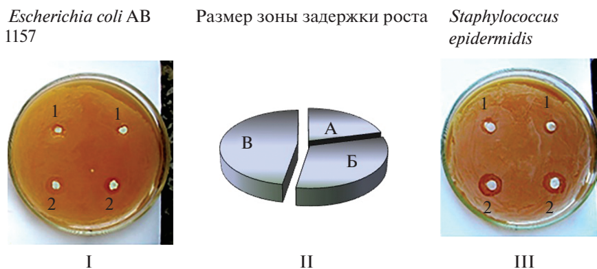
Рис. 2. Чашки Петри с нанесенными на диски гелями: 1 – гель без НЧ меди, 2 – гель с НЧ меди (I и III). Поверхностная антибактериальная активность геля (II) без НЧ меди (А) и с НЧ меди (0.002%) по отношению к E. coli AB 1157 (Б) и St. epidermidis (В).
