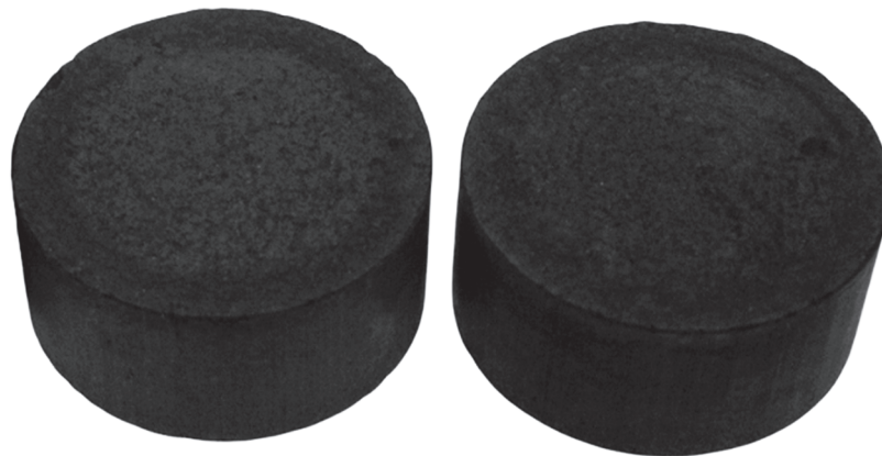
Рис. 2. Моноблоки из микропористого углеродного адсорбента АУ-6.
