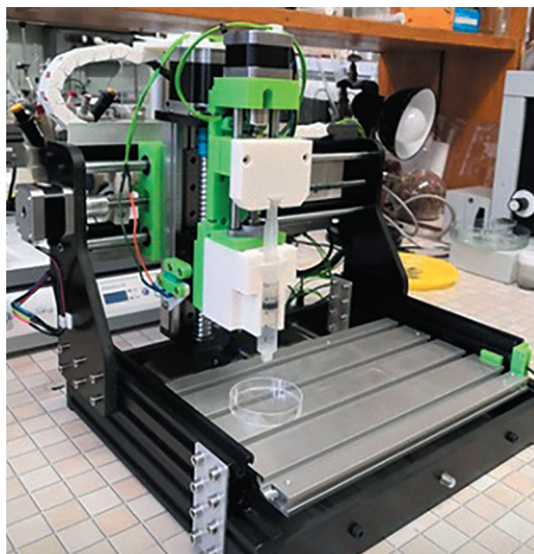
Рис. 2. Поршневой гидрогелевый 3D-биопринтер компании PharmPrint.
