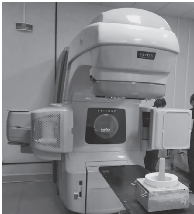
Рис. 2. Изготовленная из пластика конструкция для размещения детектора.
