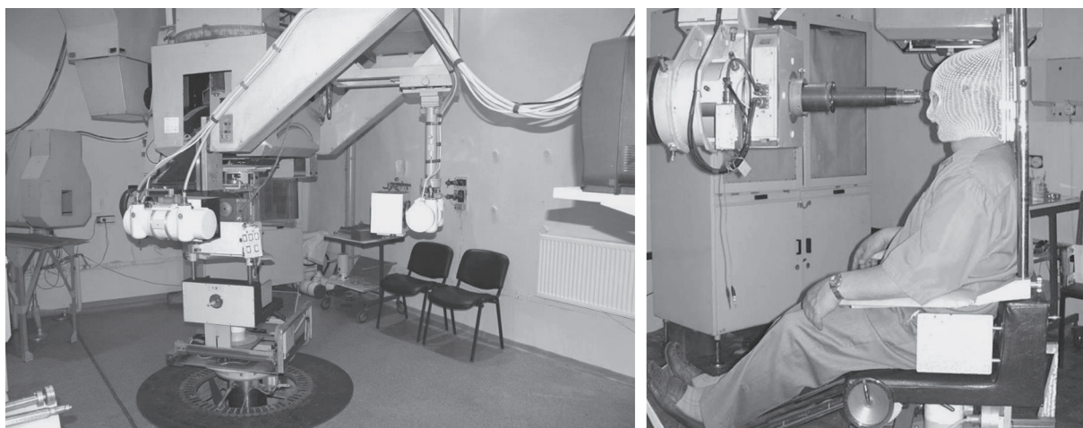
Рис. 2. Лучевая установка для проведения ПЛТ внутриглазных новообразований.
