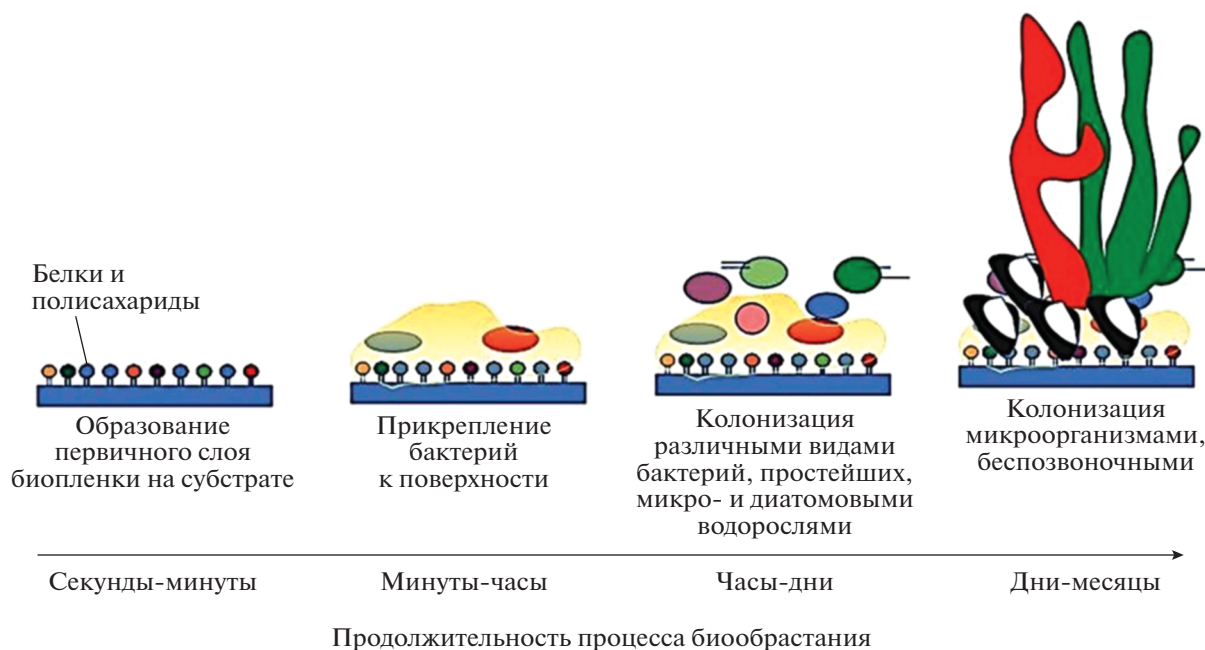
Рис. 1. Поэтапный процесс морского биообрастания [7].
