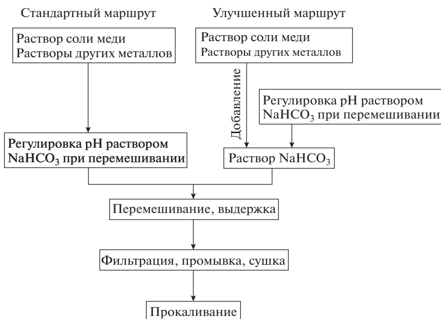
Рис. 5. Сравнение методов соосаждения для синтеза катализаторов на основе меди.
