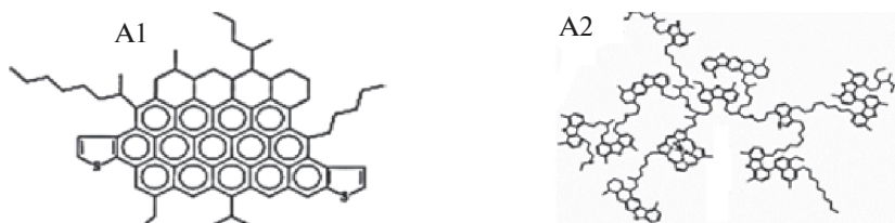
Рис. 4. Модельные молекулы асфальтенов: А1 “Континент” и А2 “Архипелаг” [51].
