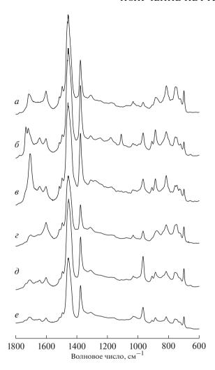
**Рис. 3.** Фрагменты ИК-спектров фракций жидких продуктов термического сольволиза резиновой крошки: a – образец 1;  $\delta$  – образец 2;  $\epsilon$  – образец 3;  $\epsilon$  – образец 4;  $\delta$  – образец 5;  $\epsilon$  – образец 6.
