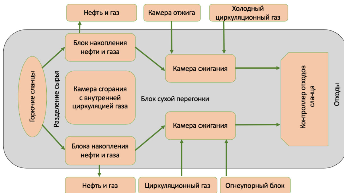
Рис. 3. Принципиальная схема печи сухой перегонки Kiviter 1000 т/сут.
